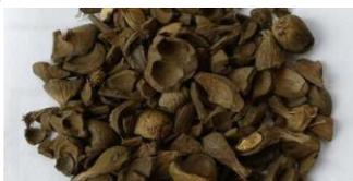
**Gambar 2.** Cangkang Kelapa Sawit(Agus Dwi,2018)
